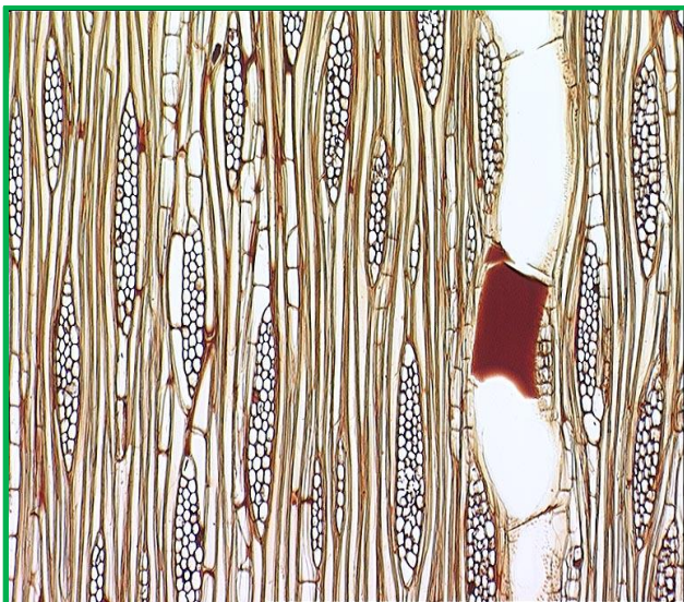
Figura. 24. Imagen microscópica, sección tangencial –Cedrela odorata.L
