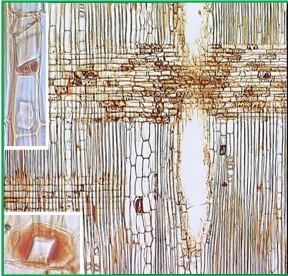
Figura.25. Imagen microscópica, sección radial - Cedrela odorata .L
