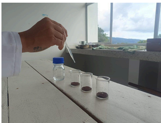
Figura 47. Adición del reactivo (5 gotas de HCl) sobre las muestras
