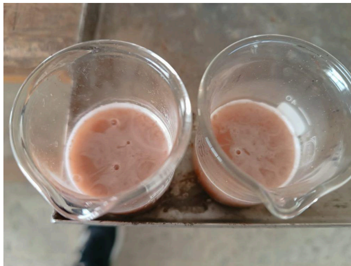
Figura 44. Reacción de las muestras con peróxido de hidrógeno; las microburbujas evidencian la oxidación de la materia orgánica
