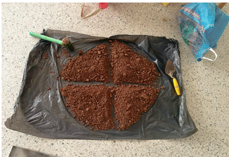
Figura 8. Proceso de cuarteo de la muestra para la obtención de una porción representativa de ensayo.
