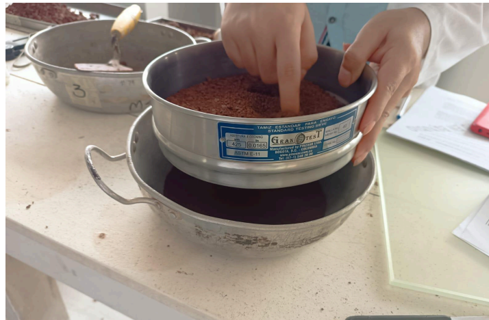
Figura 10. Proceso de tamizado de la muestra durante el ensayo granulométrico.
