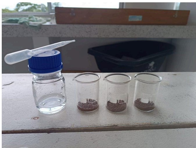
Figura 46. Muestras de 10 g en estado natural de las tres ladrilleras, previo a la adición del reactivo
