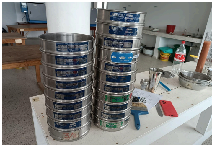
Figura 9. Serie de tamices empleada para el análisis granulométrico de las muestras.
