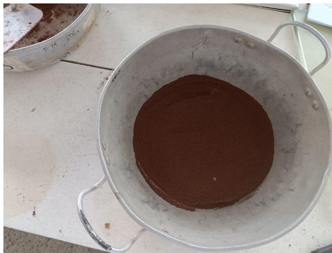
Figura 43. Muestra de suelo dispuesta en la tara metálica para el ensayo de contenido de humedad
