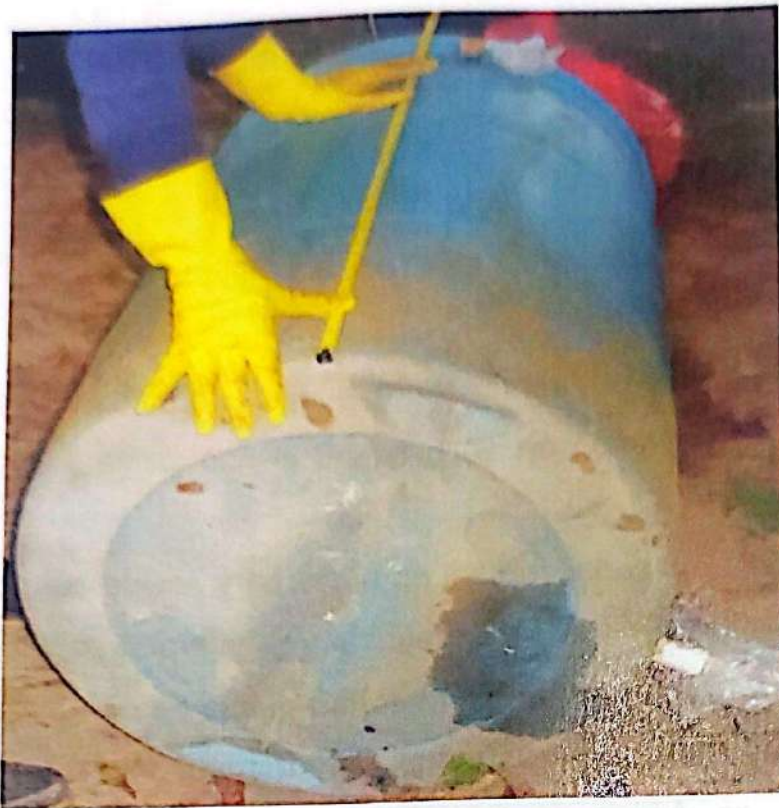
Figura 4: Recipiente para medir la densidad de los residuos sólidos.
