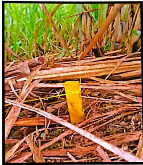
Imagen 13. Establecimiento de los clavos de erosión
