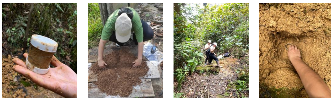
Fotografía 28-31. Muestreo para análisis fisicoquímico de suelo. Fuente: (Elaboración propia, 2025).
