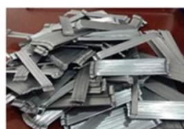
Fibras de acero con ganchos en los extremos
