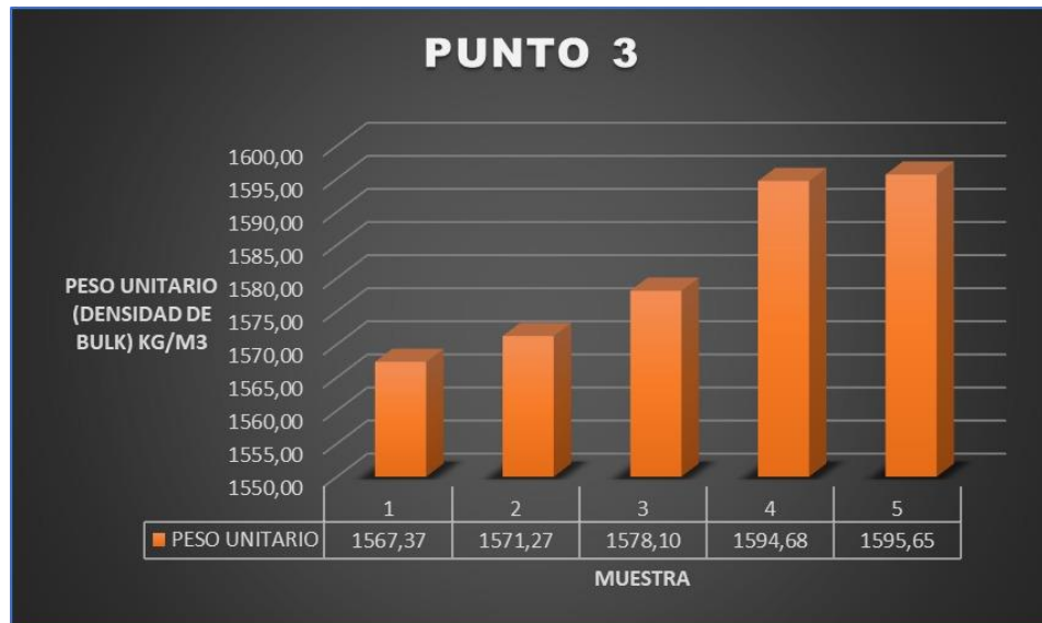
Grafica 57 Promedios de laboratorio Peso Bulk agregado grueso en estado compacto del punto de extracción 3.
