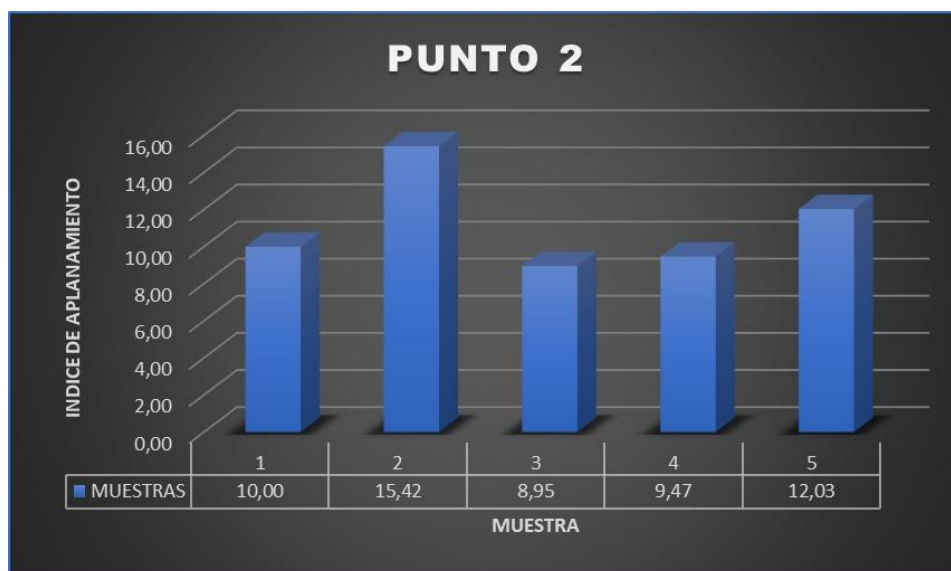
Grafica 32 Promedio del laboratorio de Índice de Aplanamiento del punto de extracción 2.
