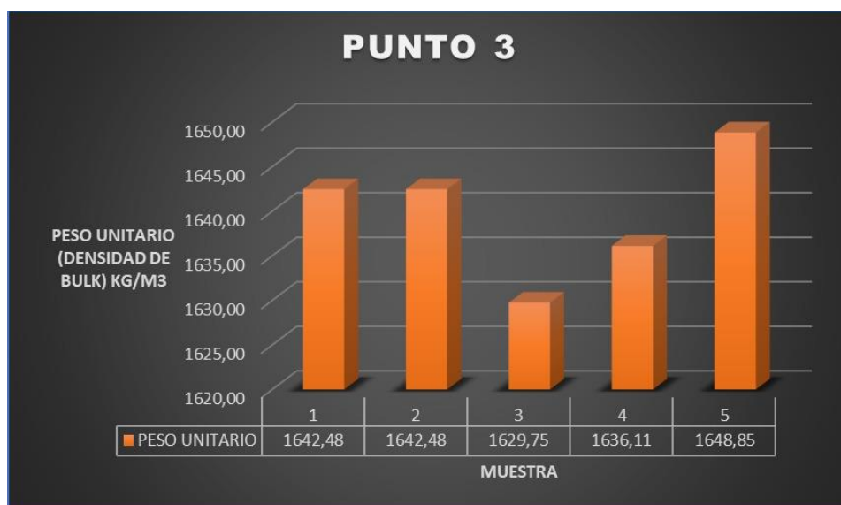
Grafica 66 Promedios de laboratorio Peso Bulk agregado fino en estado suelto del punto de extracción 3.
