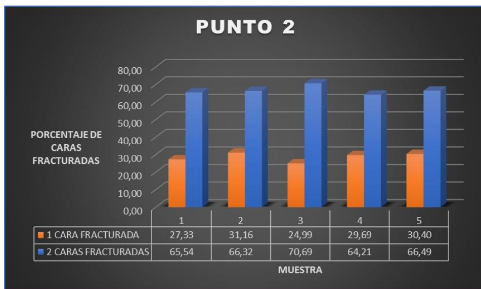
Grafica 29 Promedios del laboratorio de Caras fracturadas del punto de extracción 2.
