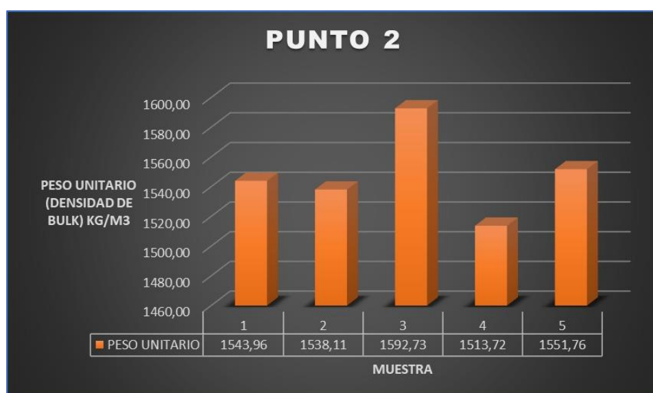
Grafica 56 Promedios de laboratorio Peso Bulk agregado grueso en estado compacto del punto de extracción 2.
