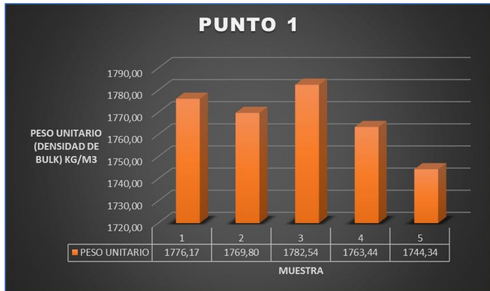
Grafica 61 Promedios de laboratorio Peso Bulk agregado fino en estado compacto del punto de extracción 1.
