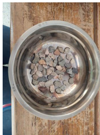
Foto 48 Muestras que pasaron el calibrador de aplanamiento.
