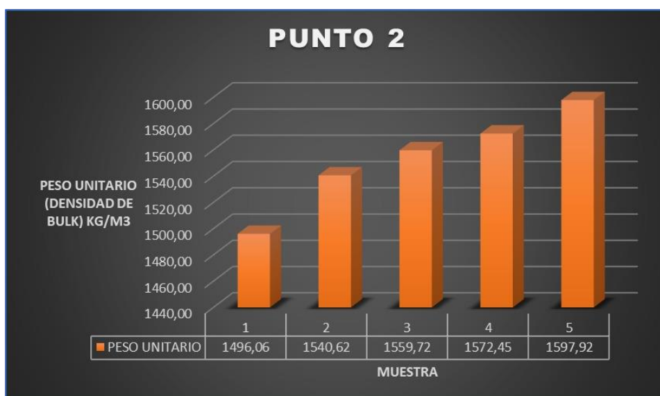
Grafica 65 Promedios de laboratorio Peso Bulk agregado fino en estado suelto del punto de extracción 2.
