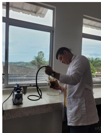
Foto 58 Retiro de vacíos con bomba de vacíos. Fuente: Desarrollada por autores
