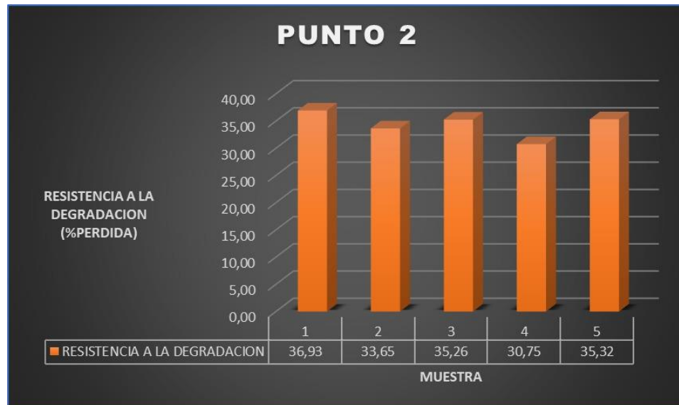
Grafica 71 Promedio de laboratorio Degradación por máquina de los ángeles en el punto de extracción 2.
