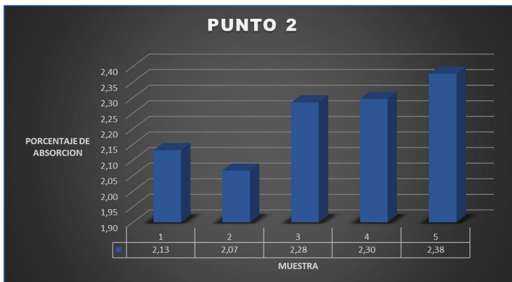
Grafica 51 Promedios del laboratorio de Absorción de agregado grueso del punto de extracción 2.
