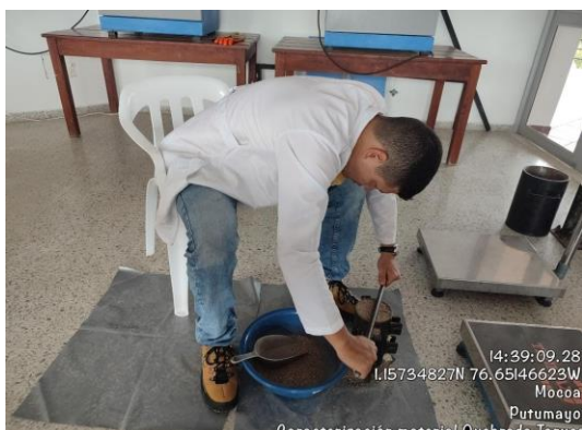
Foto 84 Enrasado de muestra en condición compacta.
