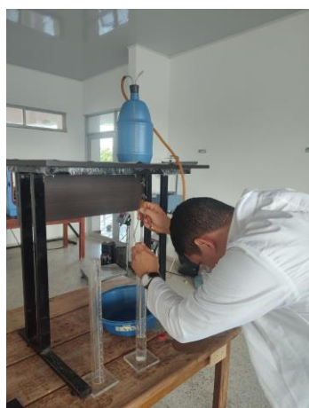
Foto 92 Solución de trabajo en tubos graduados.
