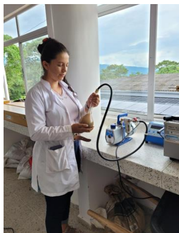
Foto 59 Retiro de vacíos con bomba de vacíos. Fuente: Desarrollada por autores
