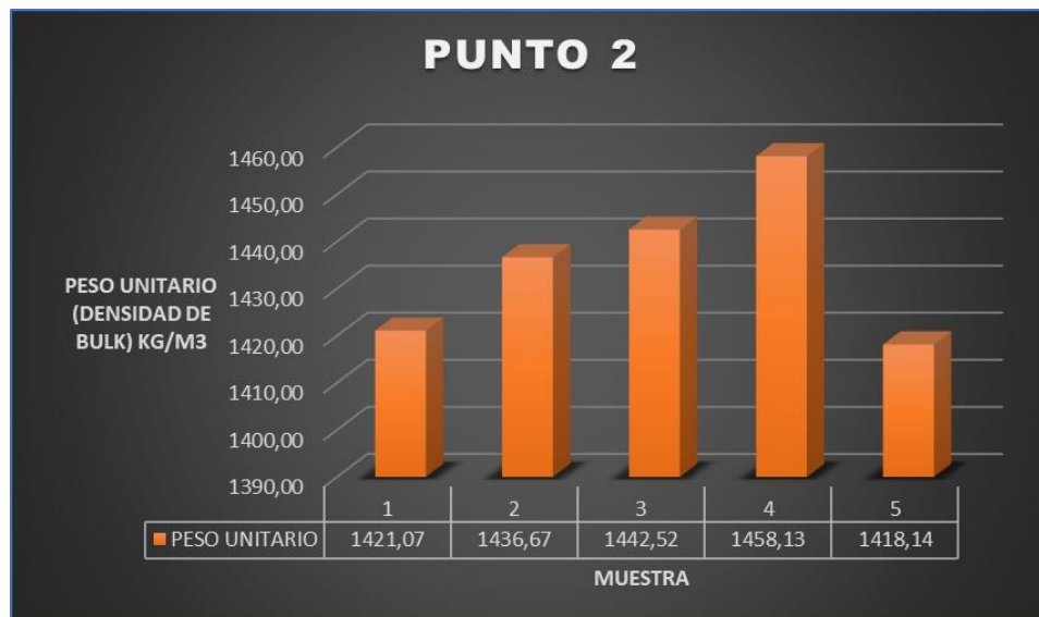
Grafica 59 Promedios de laboratorio Peso Bulk agregado grueso en estado suelto del punto de extracción 2.
