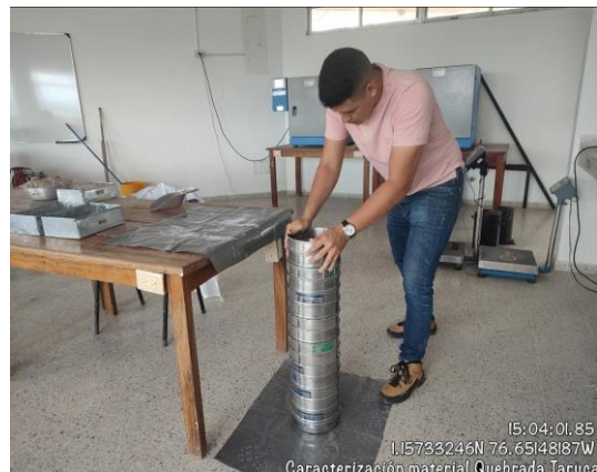
Foto 21 Granulometría por tamizado manual. Fuente: Desarrollado por autores
