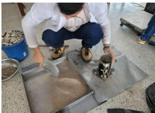
Foto 82 Ingreso de material al molde. Fuente: Desarrollada por autores
