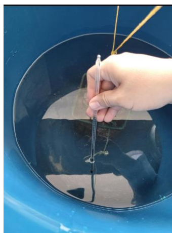
Foto 67 Toma de temperatura del agua de inmersión. Fuente: Desarrollado por autores
