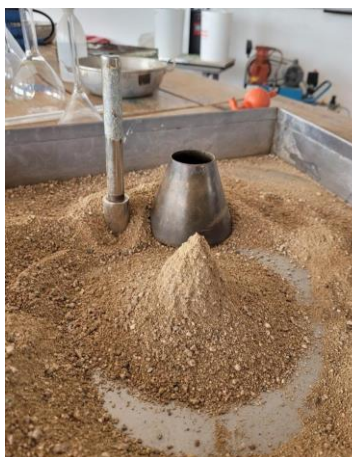
Foto 54 Prueba del cono para muestra SSS. Fuente: Desarrollado por autores
