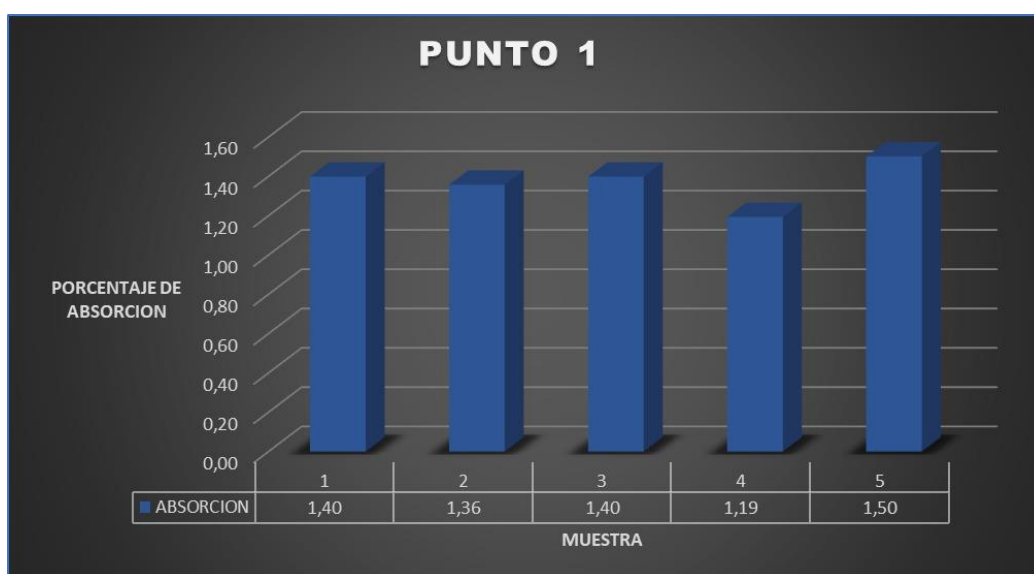
Grafica 39 Promedios del laboratorio de Absorción de agregado fino del punto de extracción 1.
