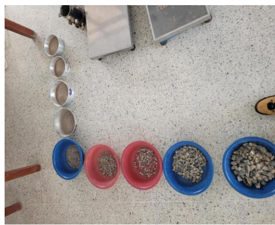
Foto 25 Separación de muestras por tamaños. Fuente: Desarrollada por autores
