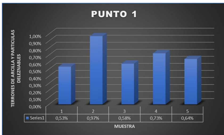
Grafica 25 Promedios del laboratorio de Terrones de arcilla y partículas deleznales del punto de extracción 1
