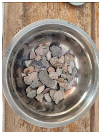
Foto 47 Muestras que pasaron el calibrador de aplanamiento.
