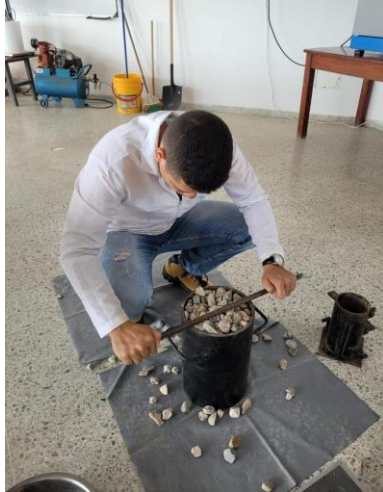
Foto 78 Enrasada peso bulk en condición compacta. Fuente: Desarrollado por autores
