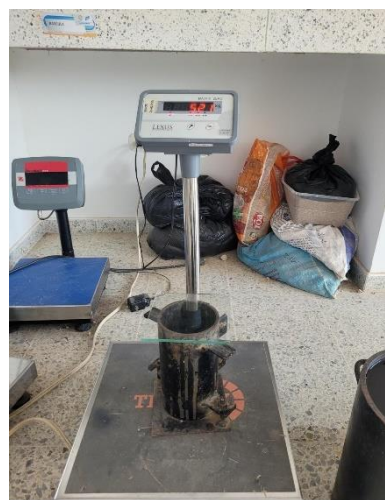
Foto 81 Calibración del recipiente (método del agua y vidrio) Fuente: Desarrollada por autores
