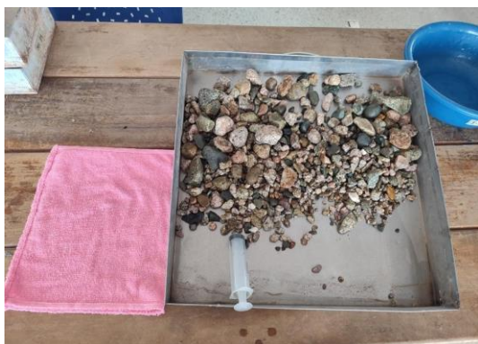
Foto 64 Retiro de agua a la muestra. Fuente: Desarrollado por autores
