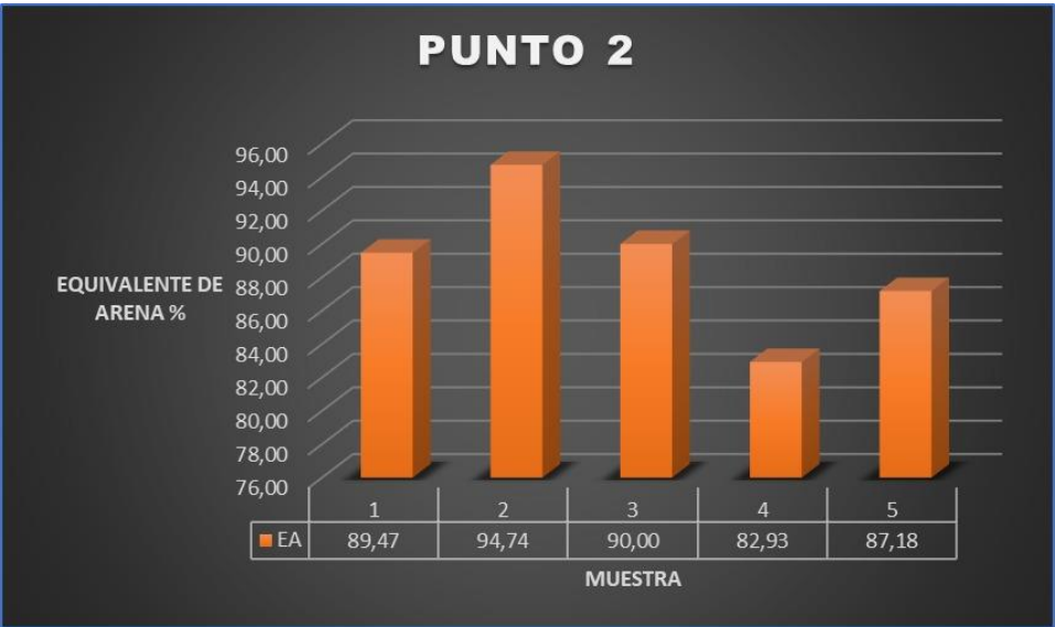
Grafica 68 Promedios del laboratorio de Equivalente de arena del punto de extracción 2. Fuente: Desarrollado por autores
