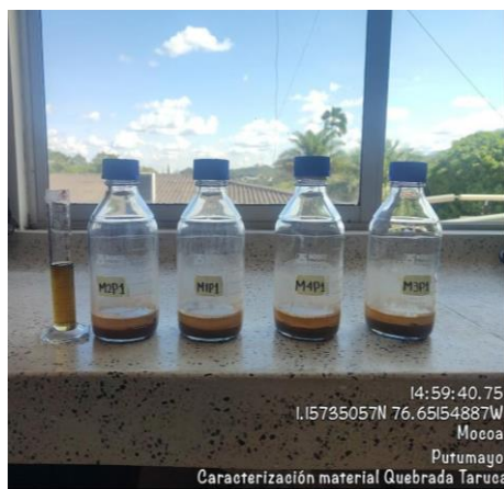
Foto 33 Presencia de impurezas en arenas.
