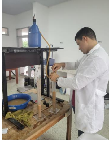
Foto 96 Llenado de tubo graduado con solución de trabajo. Fuente: Desarrollado por autores
