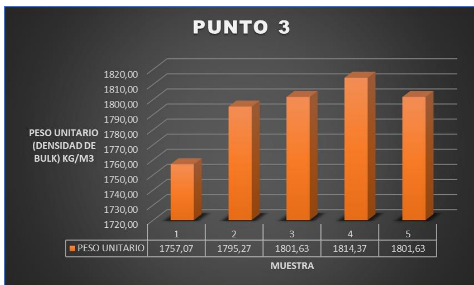
Grafica 63 Promedios de laboratorio Peso Bulk agregado fino en estado compacto del punto de extracción 3.
