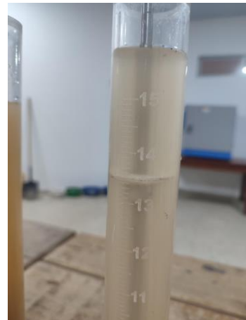
Foto 99 Lectura Equivalente de arena. Fuente: Desarrollado por autores
