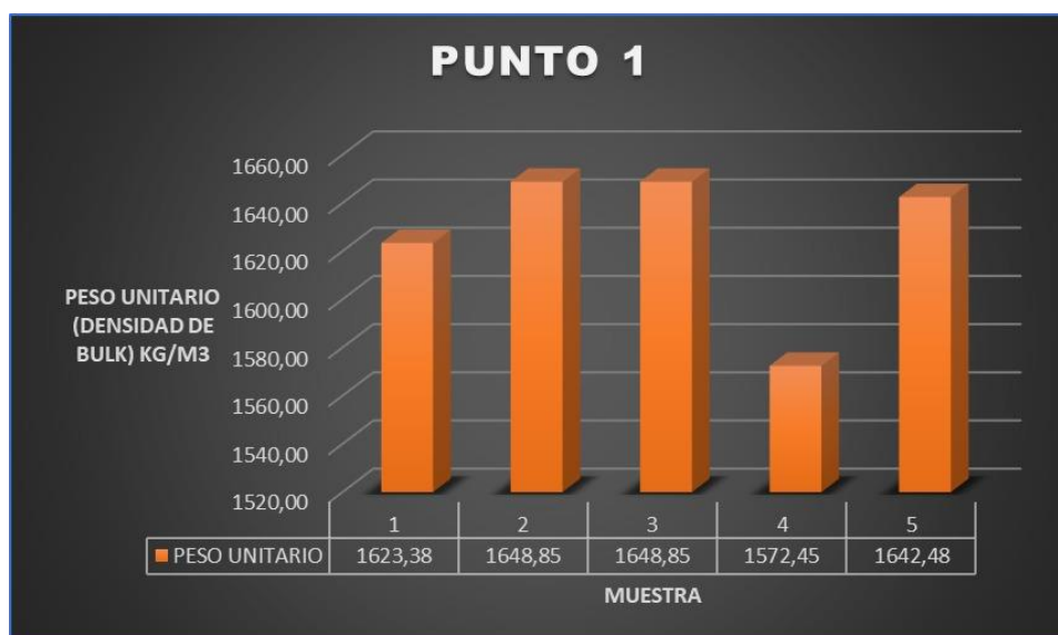
Grafica 64 Promedios de laboratorio Peso Bulk agregado fino en estado suelto del punto de extracción 1.
