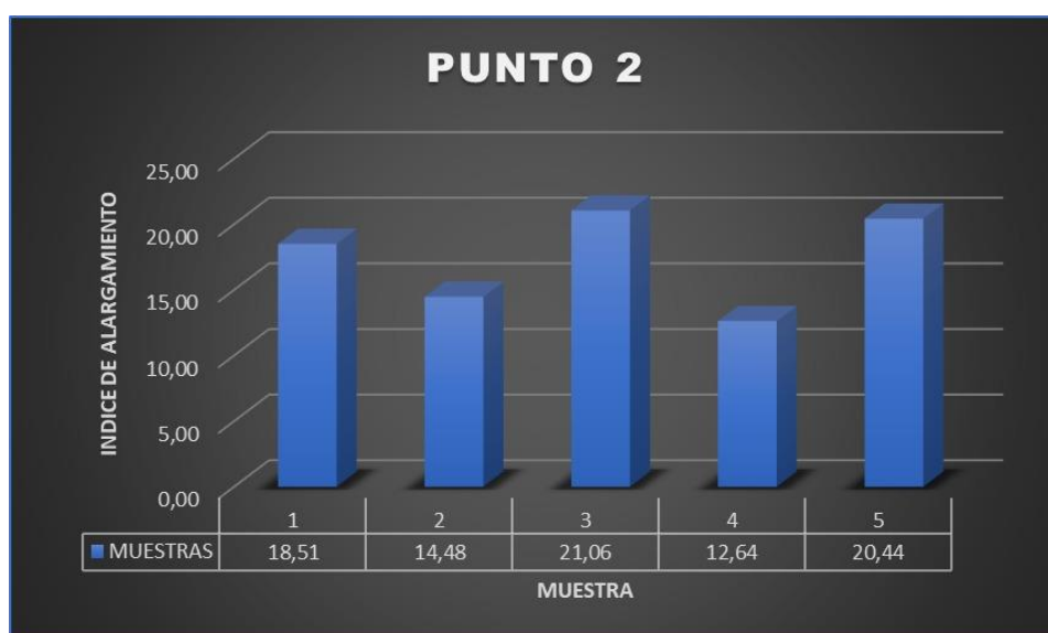
Grafica 35 Promedio del laboratorio de Índice de Alargamiento del punto de extracción 2.
