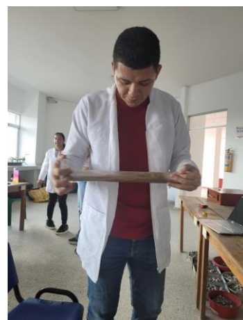
Foto 95 Agitado por 90 ciclos durante 30 segundos.
