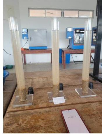
Foto 97 Muestra con solución de trabajo después de 20 minutos de reposo. Fuente: Desarrollado por autores
