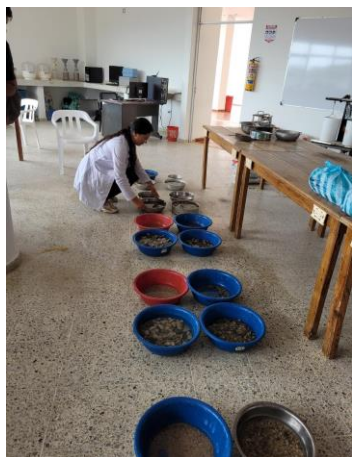
Foto 35 Inmersión de muestras en agua destilada. Fuente: Desarrollada por autores
