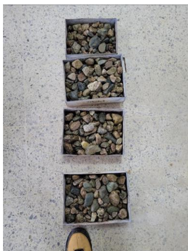
Foto 71 Muestras destinadas para peso bulk. Fuente: Desarrollado por autores
