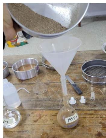
Foto 56 Ingreso de material fino en matraz con agua. Fuente: Desarrollada por autores
