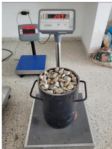
Foto 75 Peso bulk estado suelto. Fuente: Desarrollado por autores
