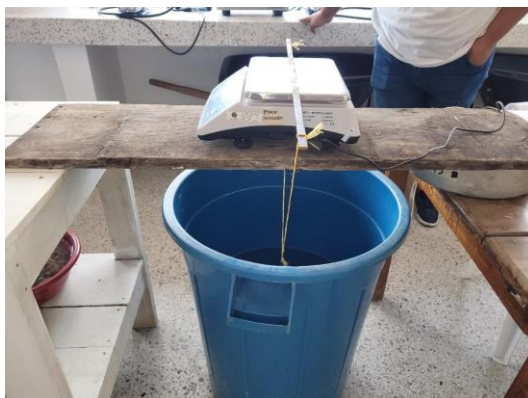
Foto 68 Equipo de trabajo para inmersión de muestras.
