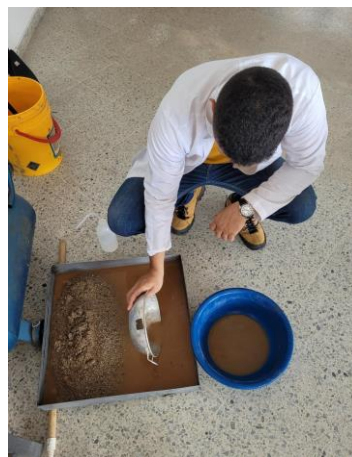
Foto 52 Retiro de agua en muestras. Fuente: Desarrollado por autores
