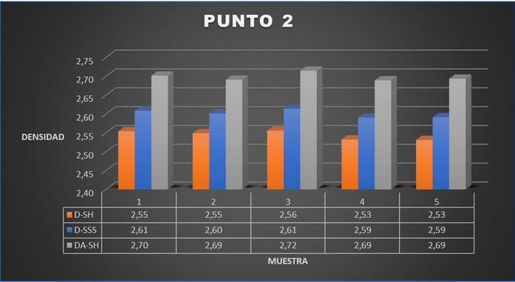
Grafica 50 Promedios del laboratorio de densidad de agregado grueso del punto de extracción 2. Fuente: Desarrollado por autores
