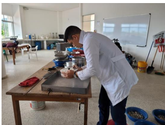
Foto 22 Prueba del minuto en tamizado. Fuente: Desarrollado por autores
