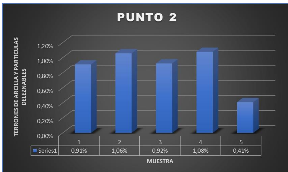
Grafica 26 Promedios del laboratorio de Terrones de arcilla y partículas deleznales del punto de extracción 2
