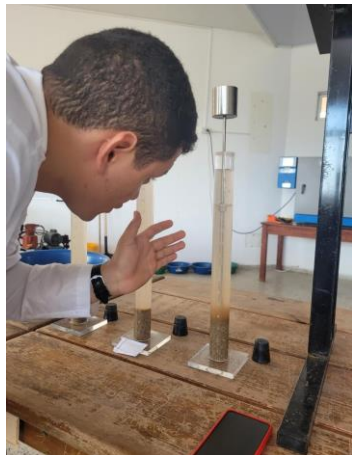
Foto 98 Lectura Equivalente de arena. Fuente: Desarrollado por autores
