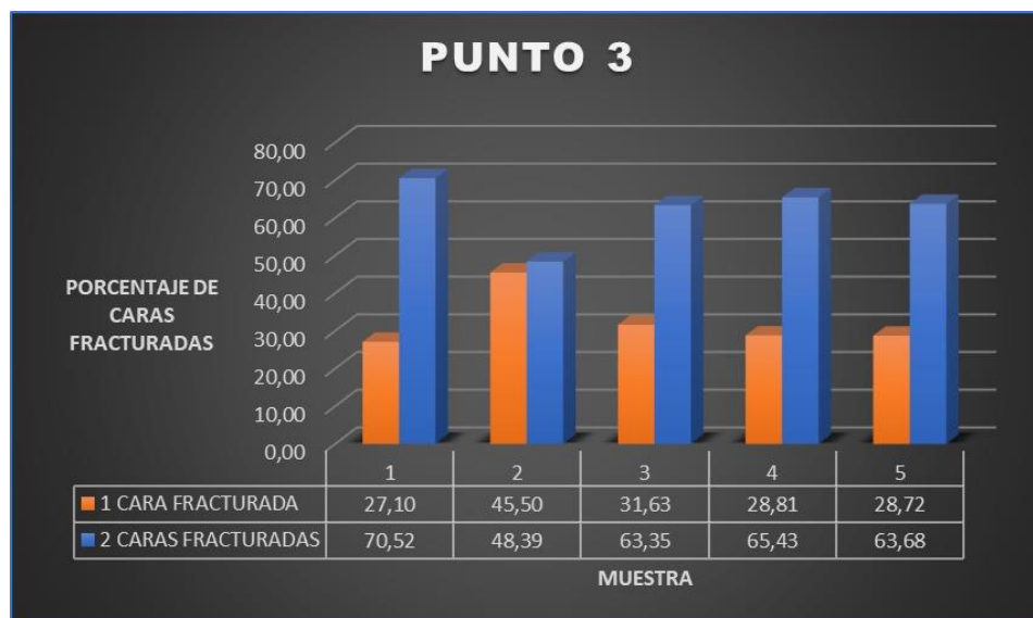
Grafica 30 Promedios del laboratorio de Caras fracturadas del punto de extracción 3
