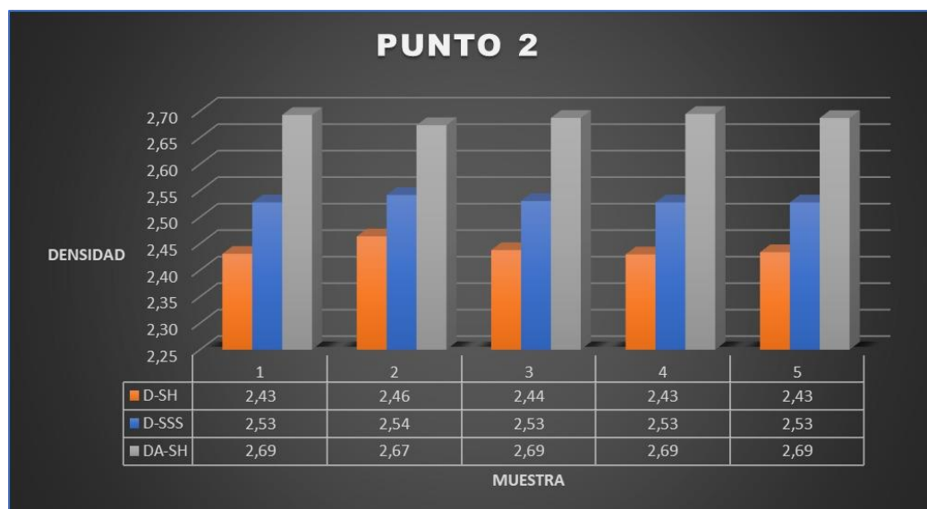
Grafica 41 Promedios del laboratorio de densidad de agregado fino del punto de extracción 2.
