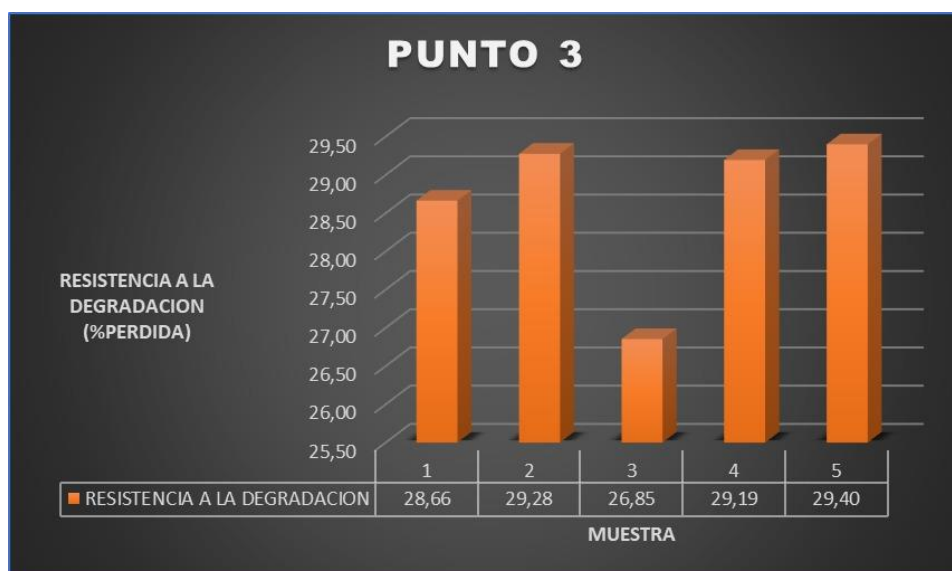
Grafica 72 Promedio de laboratorio Degradación por máquina de los ángeles en el punto de extracción 3.
