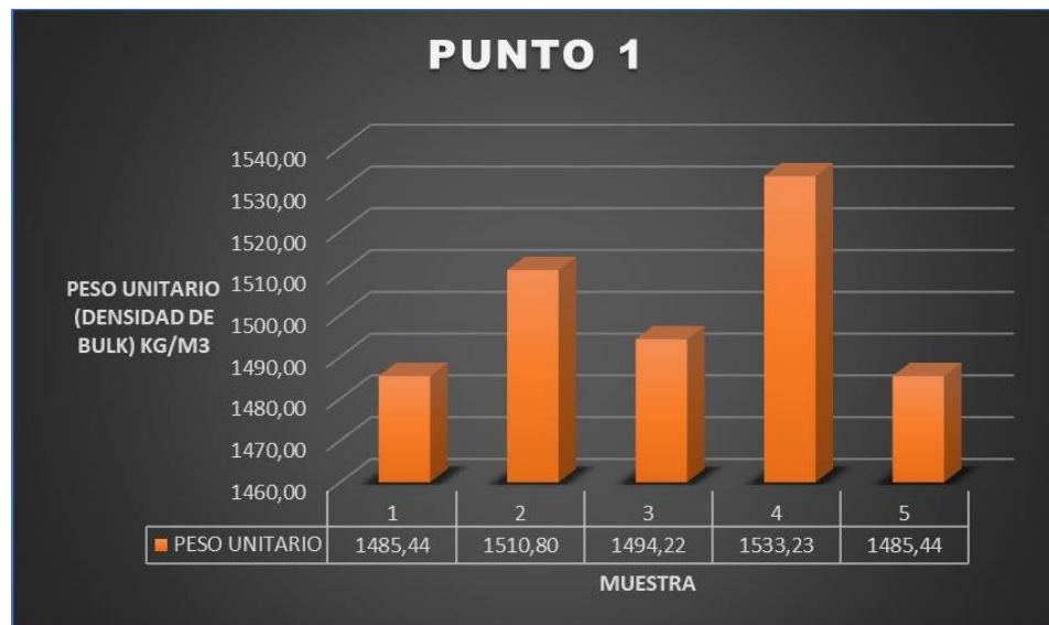
Grafica 55 Promedios de laboratorio Peso Bulk agregado grueso en estado compacto del punto de extracción 1. Fuente: Desarrollado por autores
