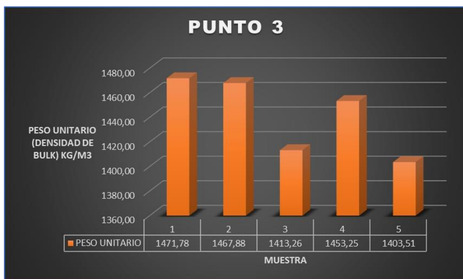
Grafica 60 Promedios de laboratorio Peso Bulk agregado grueso en estado suelto del punto de extracción 3.
