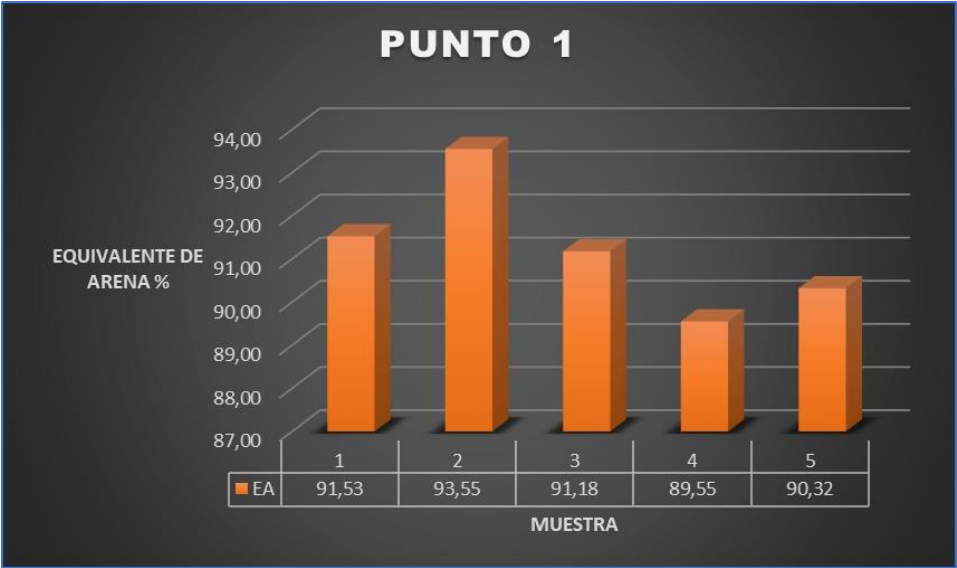
Grafica 67 Promedios del laboratorio de Equivalente de arena del punto de extracción 1. Fuente: Desarrollado por autores
