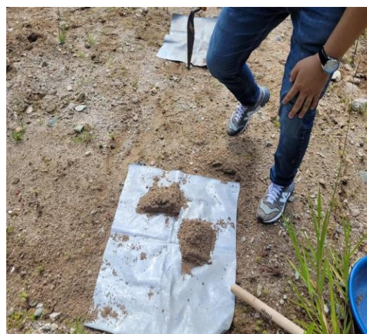
Foto 27 Material fino que pasa el tamiz No.4. Fuente: Desarrollado por autores
