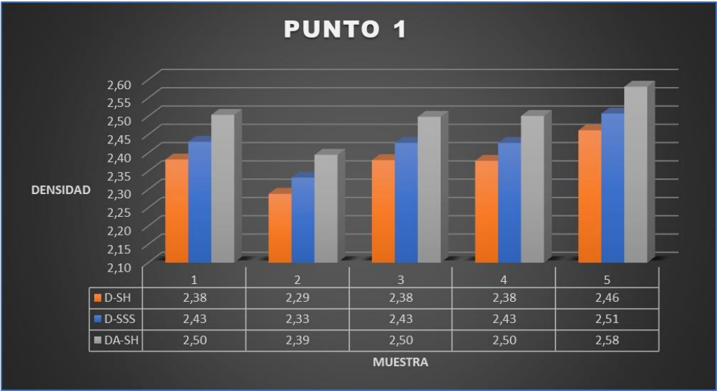
Grafica 47 Promedios del laboratorio de densidad de agregado grueso del punto de extracción 1. Fuente: Desarrollado por autores
