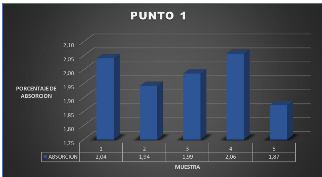
Grafica 48 Promedios del laboratorio de Absorción de agregado grueso del punto de extracción 1.
