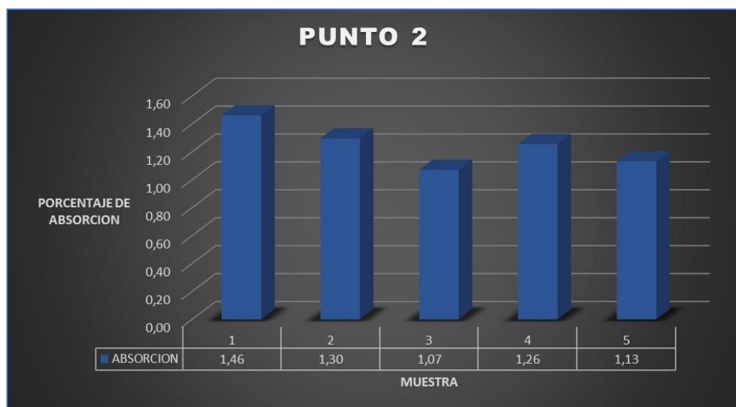
Grafica 42 Promedios del laboratorio de Absorción de agregado fino del punto de extracción 2.
