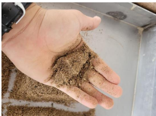
Foto 90 Prueba de humedad de la muestra.
