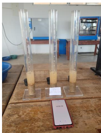
Foto 94 Muestras después de 10 minutos de agitado.
