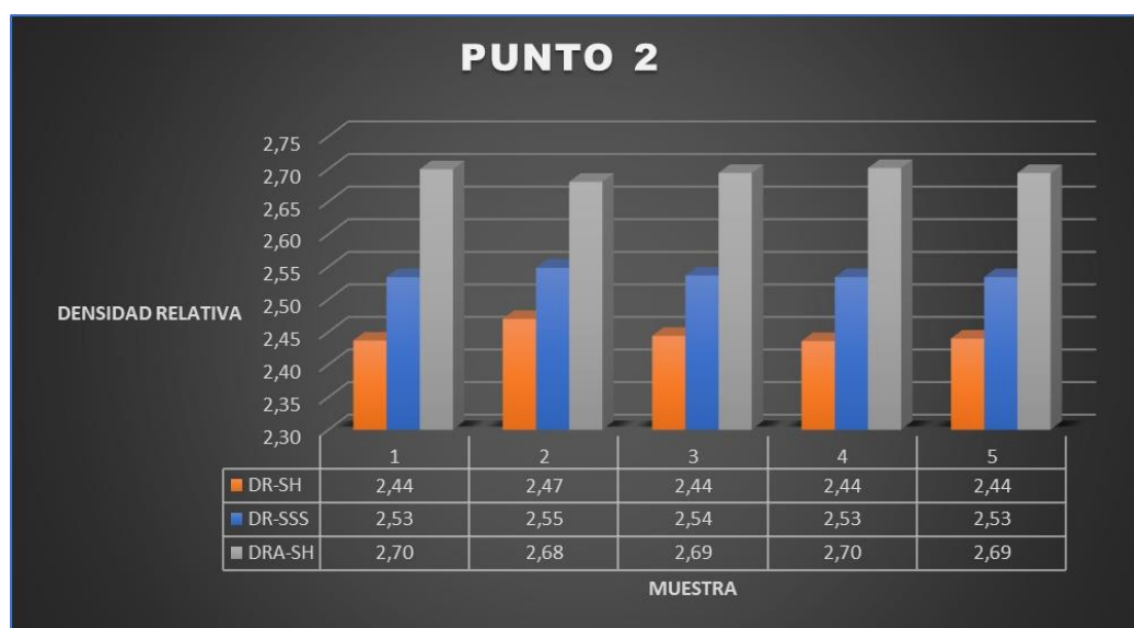
Grafica 40 Promedios del laboratorio de densidad relativa de agregado fino del punto de extracción 2.
