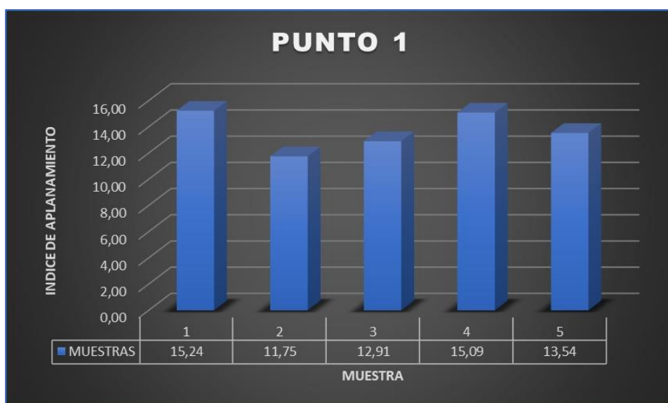
Grafica 31 Promedio del laboratorio de Índice de Aplanamiento del punto de extracción 1.
