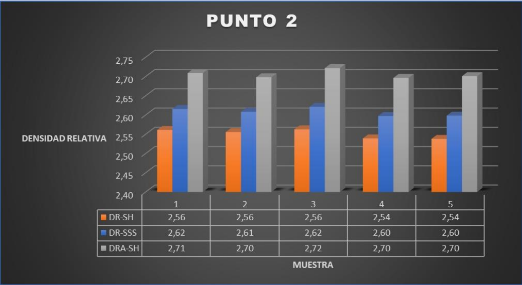
Grafica 49 Promedios del laboratorio de densidad relativa de agregado grueso del punto de extracción 2. Fuente: Desarrollado por autores
