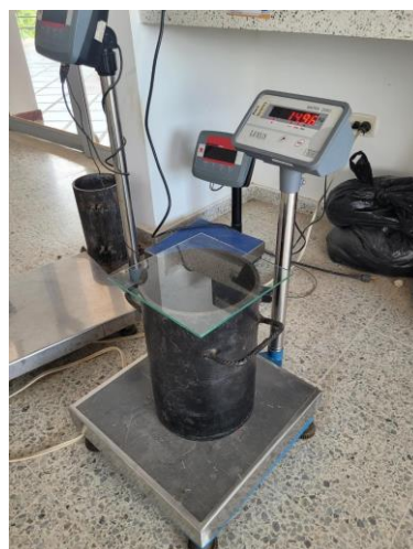
Foto 72 Calibración de equipo (método del agua y vidrio). Fuente: Desarrollado por autores
