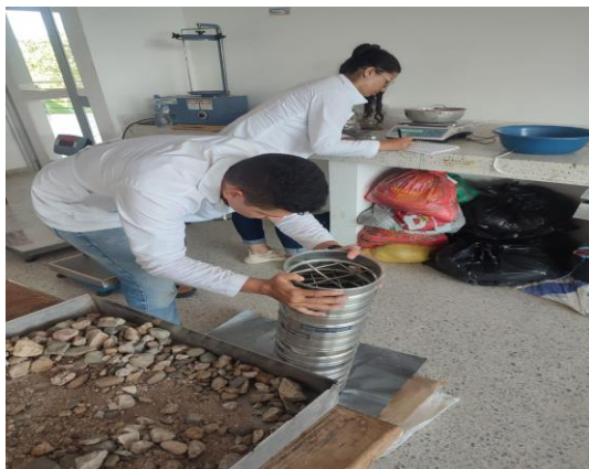
Foto 20 Granulometría por tamizado manual. Fuente: Desarrollado por autores
