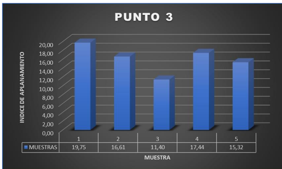
Grafica 33 Promedio del laboratorio de Índice de Aplanamiento del punto de extracción 3.
