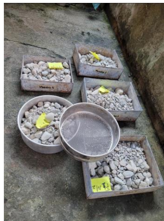
Foto 105 Resultado de tamizado de muestras. Fuente: Desarrollado por autores
