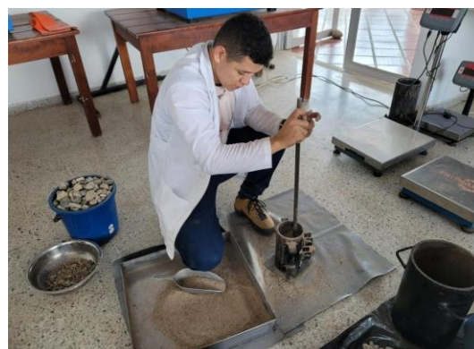
Foto 83 Primera capa de material fino en condición compacta. Fuente: Desarrollada por autores
