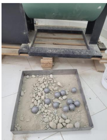
Foto 102 Muestras después de realizar ensayo en máquina de los ángeles. Fuente: Desarrollado por autores
