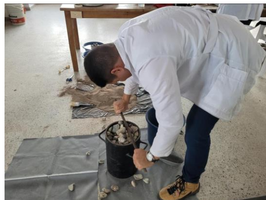
Foto 74 Enrasado de peso bulk en condición suelta. Fuente: Desarrollado por autores
