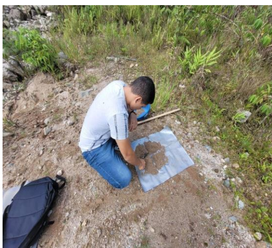
Foto 26 Cuarteo de material fino que pasa el tamiz No.4. Fuente: Desarrollado por autores
