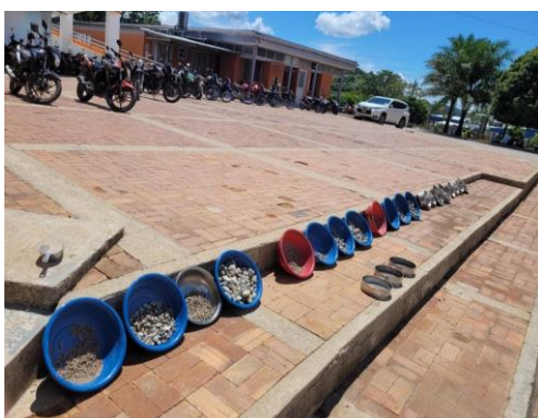
Foto 39 Lavado de material para partículas deleznales. Fuente: Desarrollada por autores
