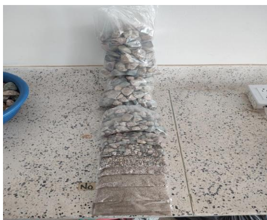
Foto 24 Separación de muestras por tamaños. Fuente: Desarrollada por autores
