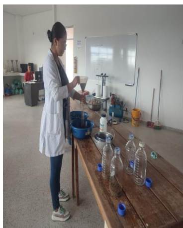
Foto 29 Medición de finos para ensayo de impurezas. Fuente: Desarrollada por autores
