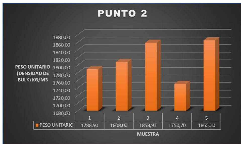
Grafica 62 Promedios de laboratorio Peso Bulk agregado fino en estado compacto del punto de extracción 2.
