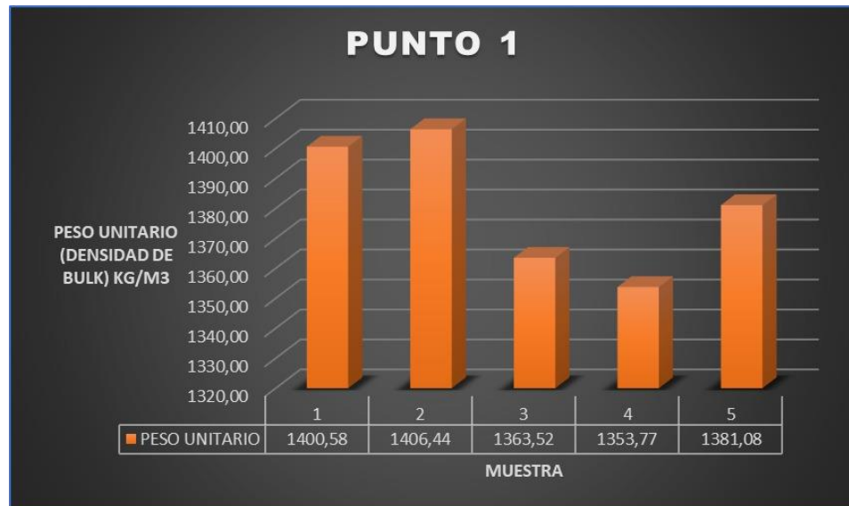
Grafica 58 Promedios de laboratorio Peso Bulk agregado grueso en estado suelto del punto de extracción 1.
