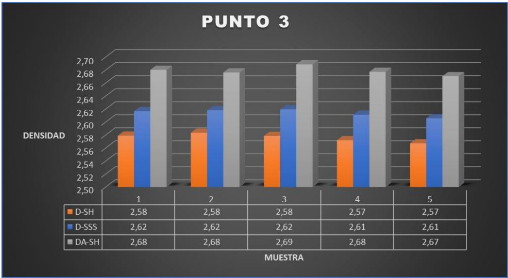
Grafica 44 Promedios del laboratorio de densidad de agregado fino del punto de extracción 3. Fuente: Desarrollado por autores
