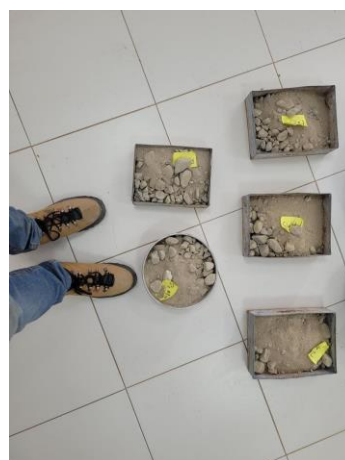
Foto 103 Muestras después de ingresar en máquina de los ángeles. Fuente: Desarrollado por autores
