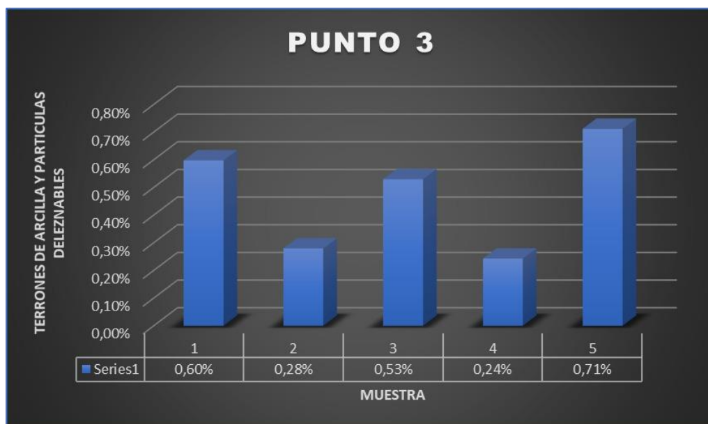
Grafica 27 Promedios del laboratorio de Terrones de arcilla y partículas deleznales del punto de extracción 3
