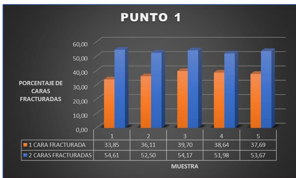
Grafica 28 Promedios del laboratorio de Caras fracturadas del punto de extracción 1
