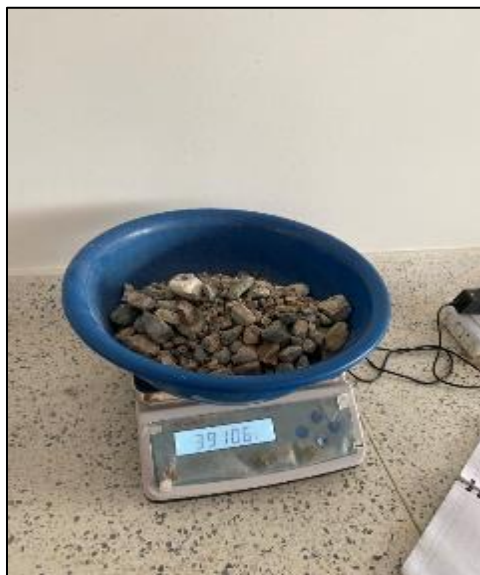
Figura 34. Secado y determinación de la masa
