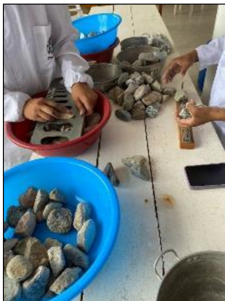
Figura 47. Partículas clasificadas en planas y alargadas.
