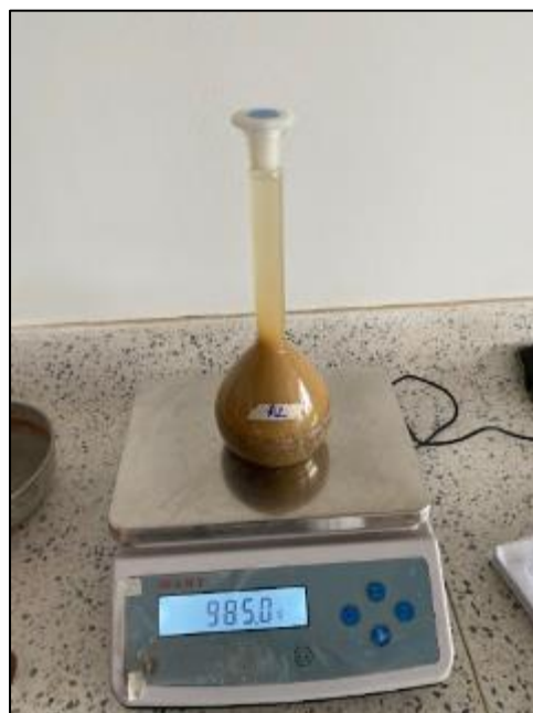
Figura 40. Masa de muestra superficialmente saturada.
