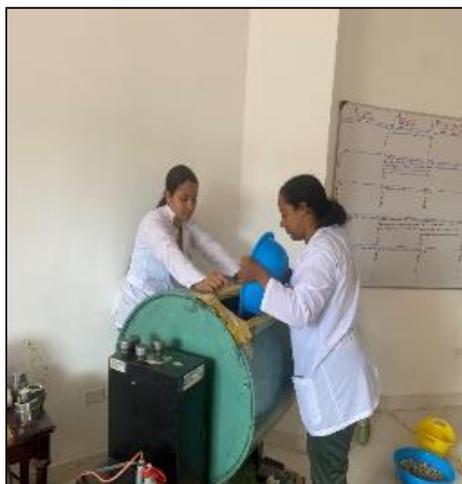
Figura 31. Ingreso de la muestra a la maquina de los Ángeles.
