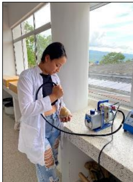
Figura 40. Masa de muestra superficialmente saturada.
