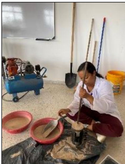
Figura 30. Apisonamiento del agregado
