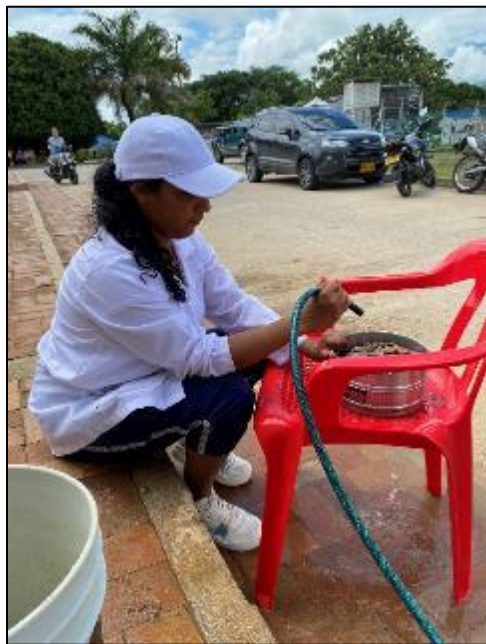
Figura 25. Lavado muestra a través del tamiz N° 4 y N°200.
