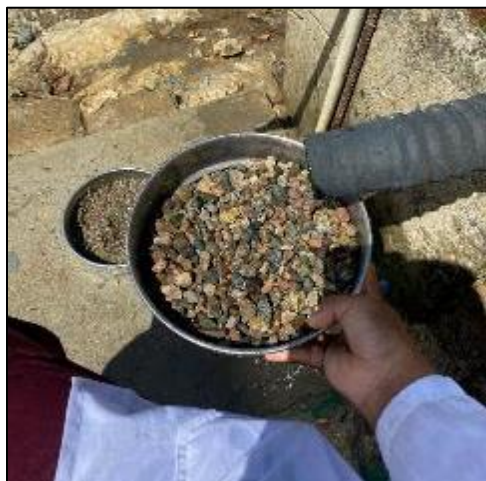
Figura 19. Lavado de las muestras a través de los tamices.
