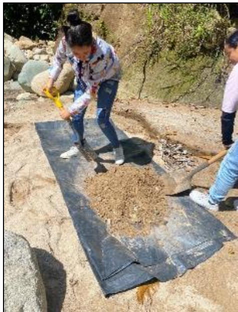
Figura 7. Formación de la pila cónica.
