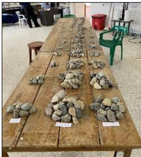
Figura 46. Partículas fracturadas, no fracturadas y de frontera.
