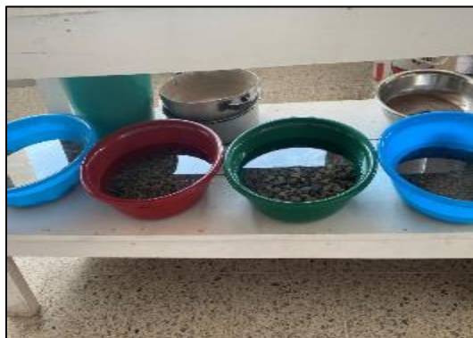
Figura 17. Material sumergido 24 horas.
