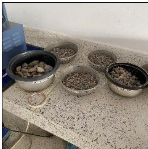
Figura 20. Secado y peso de las muestras.
