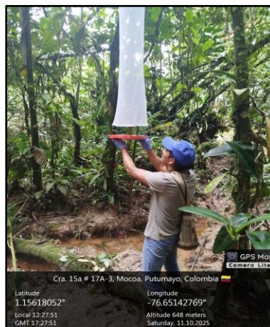
Figura 25. Montaje de la trampa Van Someren-Rydon
