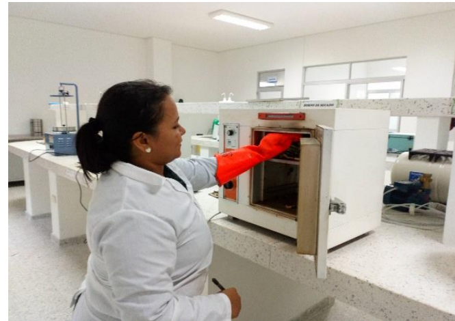
Fotografía 6 Ingreso de probetas al horno
